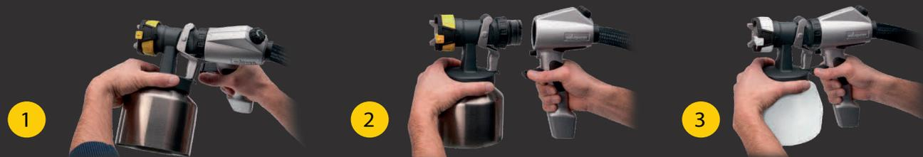
1. Распылительная насадка меняется за считанные секунды. Нажмите на фиксатор, чтобы освободить насадку и поверните её на 90°.
